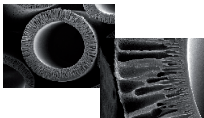
MEDISULFONE®: sezione e morfologia di una singola fibra capillare cava
